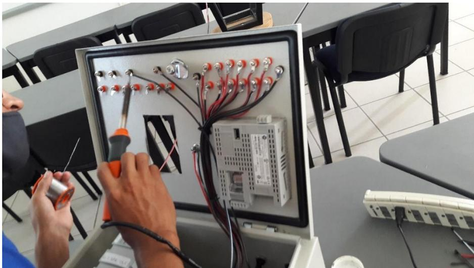
**Figura 24.** Proceso de soldadura de los cables para las salidas del PLC del gabinete.
