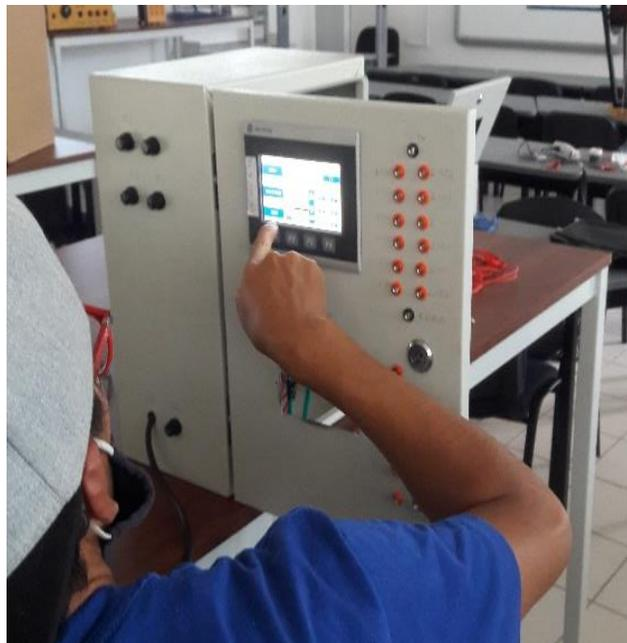
**Figura 28.** Configuración de la Panel View y el PLC, dentro del gabinete.
