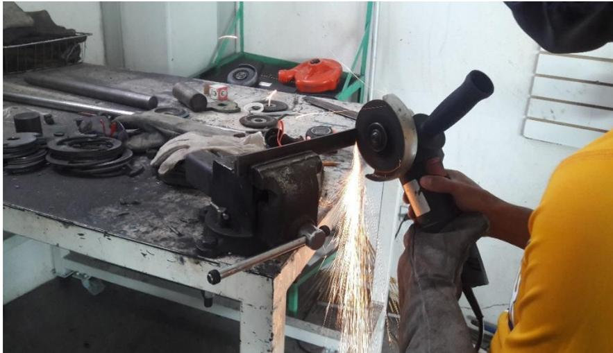
**Figura 20.** Proceso de utilización de la pulidora/cortadora de mano, para la construcción de la base del PLC.
