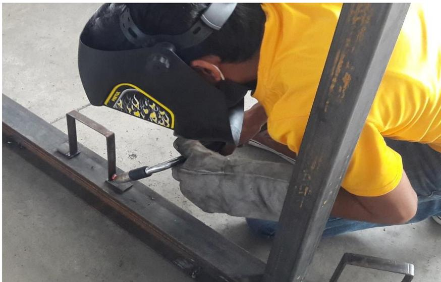
**Figura 19.** Proceso de utilización de la máquina de soldar de micro alambre, para la construcción de la base del PLC.
