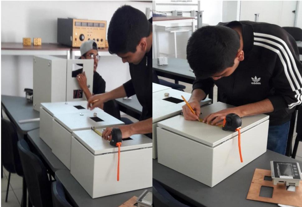
**Figura 31.** Realización de mediciones en los gabinetes para las ranuras y las perforaciones de la Panel View, el PLC y los conectores banana hembra (jacks banana hembra), respectivamente.
