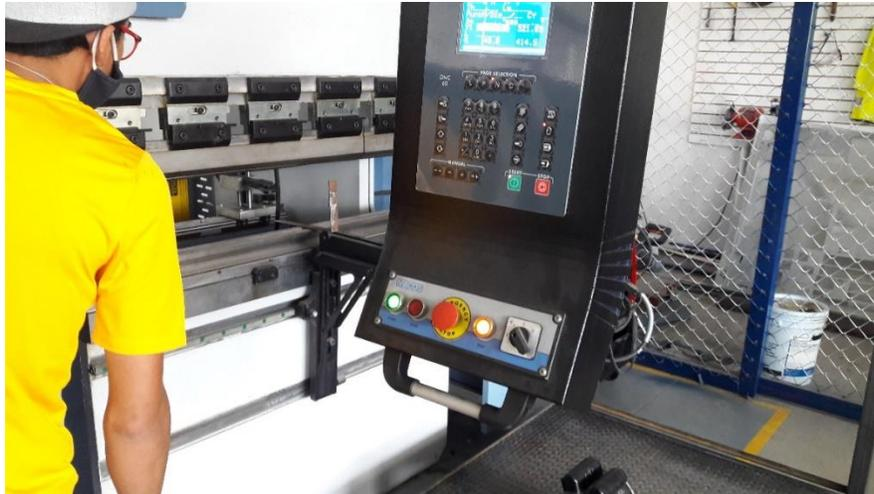
**Figura 18.** Proceso de utilización de la prensa dobladora, para la construcción de la base del PLC.
