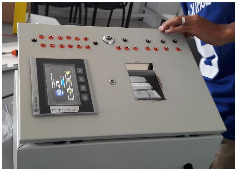
**Figura 26.** Energización del gabinete para corroborar el encendido de la Panel View y el PLC.
