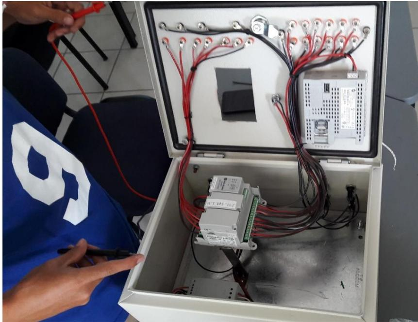
**Figura 25.** Realización de pruebas para corroborar la continuidad de los cables y acomodo de los cables dentro del gabinete.
